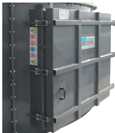
PORTA DI MANUTENZIONE RINFORZATA PORTE DE MAINTENANCE RENFORCÉE REINFORCED MAINTENANCE DOOR VERSTÄRKTE WARTUNGSTÜR PUERTA DE MANTENIMIENTO REFORZADA
